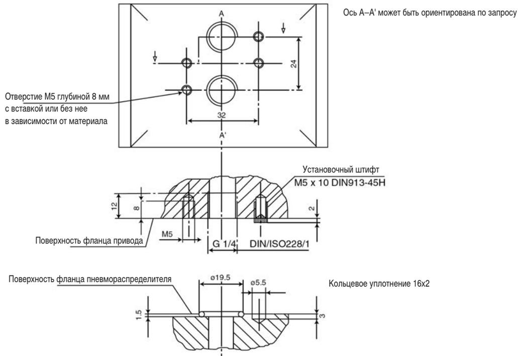
Пневмораспределитель может быть закреплен двумя монтажными болтами
